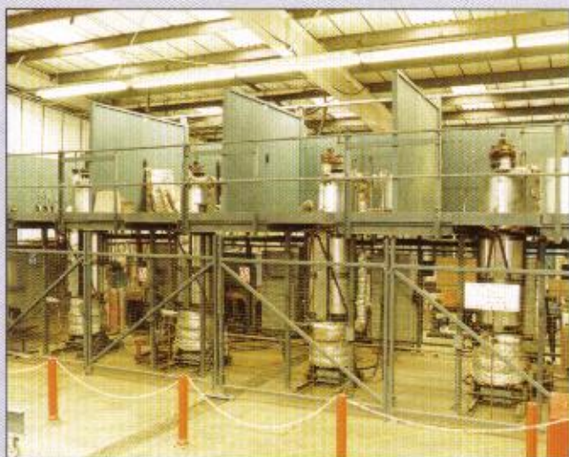
Installation BHRG utilisée pour l'essai de CHIEFTAIN à la vapeur
