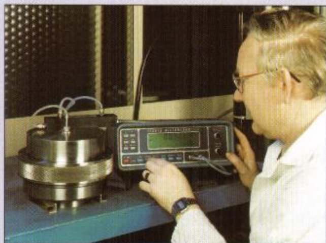
Installation pour le test de vieillissement de JAMES WALKER
